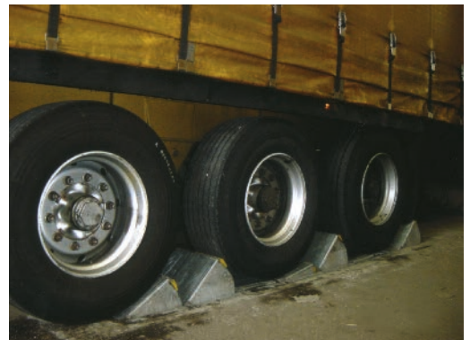
Photo 7.9. Dispositif de calage dynamique.
