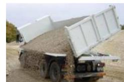
En effet, ce type de machine a été impliqué dans la survenue d'accidents graves ou mortels. Ils sont survenus lors du croisement du camion benne avec un autre véhicule, lorsque la ridelle, restée ouverte horizontalement au démarrage du camion et durant la circulation sur la route est venue percuter et cisailer le côté gauche du véhicule
